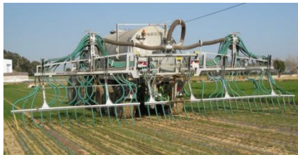
Aplicació amb mànegues
